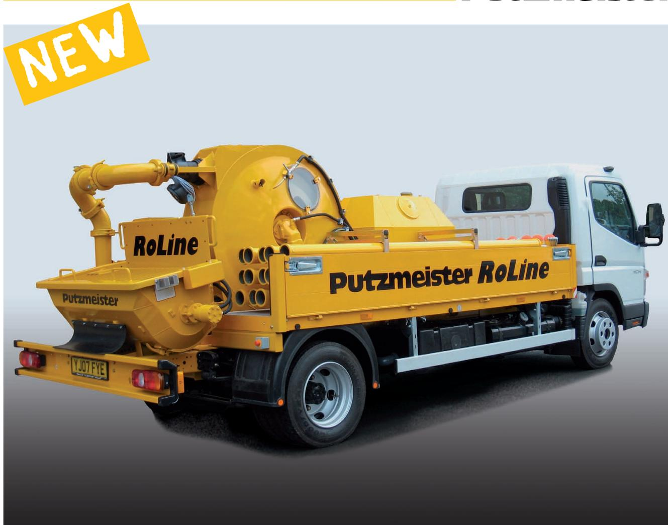
La pompe à béton conçue pour les petits constructeurs et les applications domestiques intègre dans une solution pratique et rentable une série de caractéristiques élaborées sur mesure pour répondre à la demande du marché.
