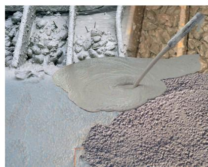
Refoule une large de gamme de matériaux y compris les matériaux difficiles : béton à fibres d'acier, chape fluide, béton cellulaire, béton auto-compactant, béton fluide, béton léger jusqu'à une distribution de particules de 32 mm. Pompe même les matériaux concassés s'il y a une bonne part de particules fines dans la pâte de béton.
