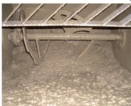
Pratiquement aucun reste de béton – presque 100% du béton dans la trémie peuvent être refoulés sur le site de construction. L'élimination coûteuse des résidus de béton est évitée.
